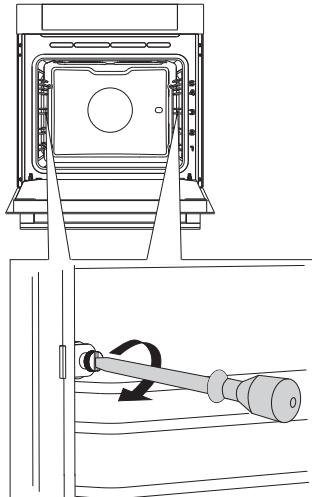
**1** Открутите винт с помощью отвертки.
