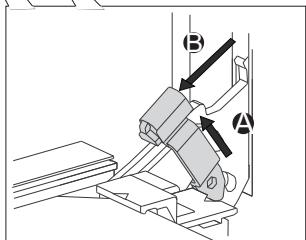
**2** Поднимите фиксаторы дверцы и потяните их на себя.
