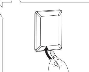
**1** С помощью отвертки снимите крышку.
