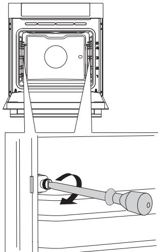
**1** Открутите винт с помощью отвертки.
